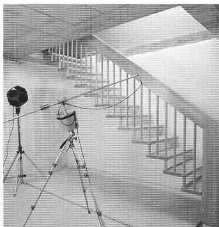
Schallmessung in horizontaler und diagonaler Richtung
