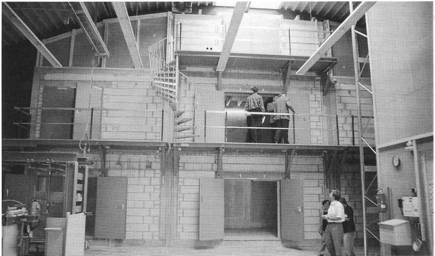
In Europas größtem und modernstem Prüfstand für Treppen können nun die unterschiedlichsten Treppeneinbau- und -aufbausituationen nachgestellt und geprüft werden
